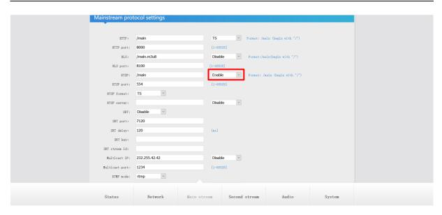
Außerdem stellen Sie bitte "ONVIF" auf "Enable". Des Weiteren können sie im Feld "ONVIF chn name" den Kanalnamen bestimmen. Wählen Sie hier einen beliebigen Namen, wie z.B. die Bezeichnung Ihrer Maschine in der aufgezeichnet wird. Anschließend bestätigen Sie die Eingaben mit "Set Up".
