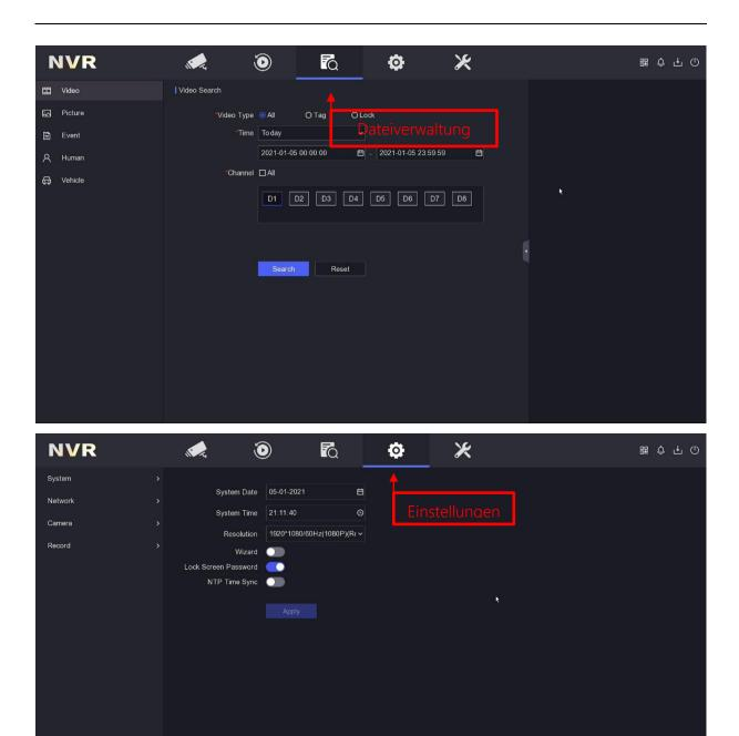
Da der Video Encoder und der NVR mittels ONVIF Protokoll miteinander kommunizieren, kann es sein, dass die Kameras erkannt werden und in der Liveansicht schon angezeigt werden. Sollte dies nicht der Fall sein, so öffnen Sie bitte die IP-Einstellungen über das Stiftsymbol. Nun können die entsprechenden Einstellungen zur Verbindung mit den Uyar-Video-Encodern vorgenommen werden.
